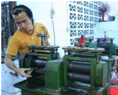
ภาพ 4 เครื่องรีดแผ่นและรีดเป็นเส้นโดยใช้แรงงานคน
