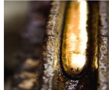
ภาพ 3 เมื่อเย็นตัวลงจะเป็นแท่งเงินสำหรับนำไปรีดเป็นแผ่นหรือเป็นเส้นตามต้องการ
