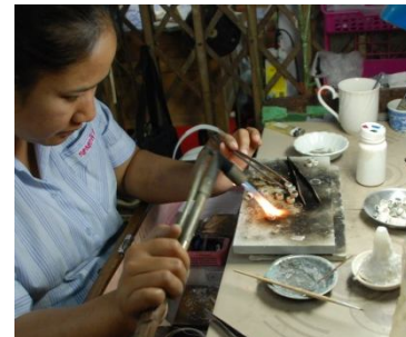
ภาพ 6 การเชื่อมชิ้นส่วนต่างๆ ด้วยน้ำยาประสานทอง
